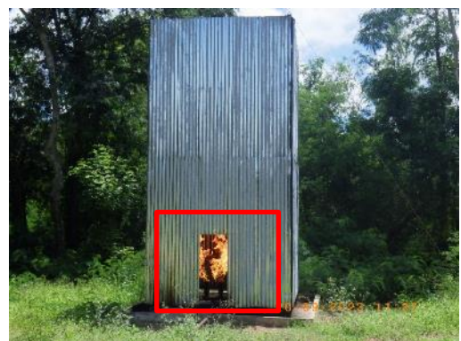
รูปที่ 2-5 ปล่องเผาก๊าซแบบแนวนอนและกำแพงสังกะสีล้อมรอบปล่องเผาก๊าซ
